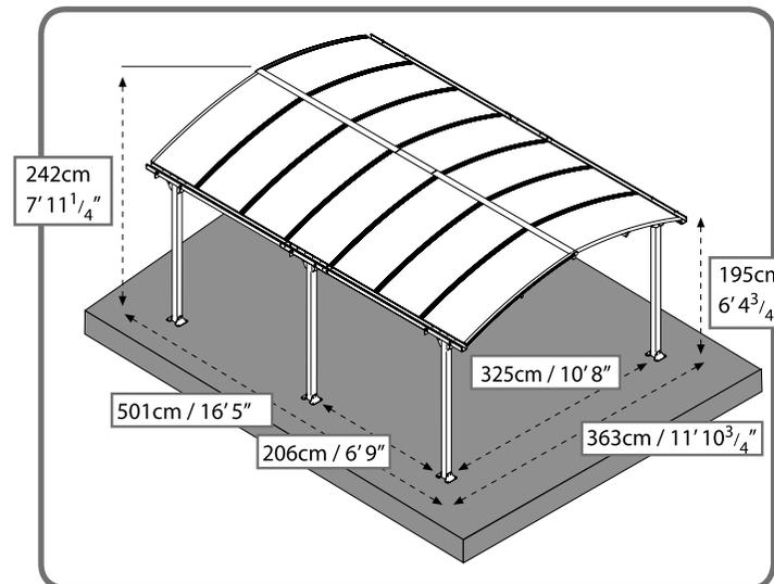
⇒ Während des Aufbaus werden einige Schrauben mit Hilfe eines Schraubenschlüssels festgezogen, während andere erst nach dem Aufbau und der Justierung des gesamten Carports festgezogen werden.
