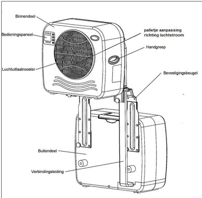
Controlepaneel, zie hoofdstuk 'gebruik' voor uitleg van het controlepaneel.
