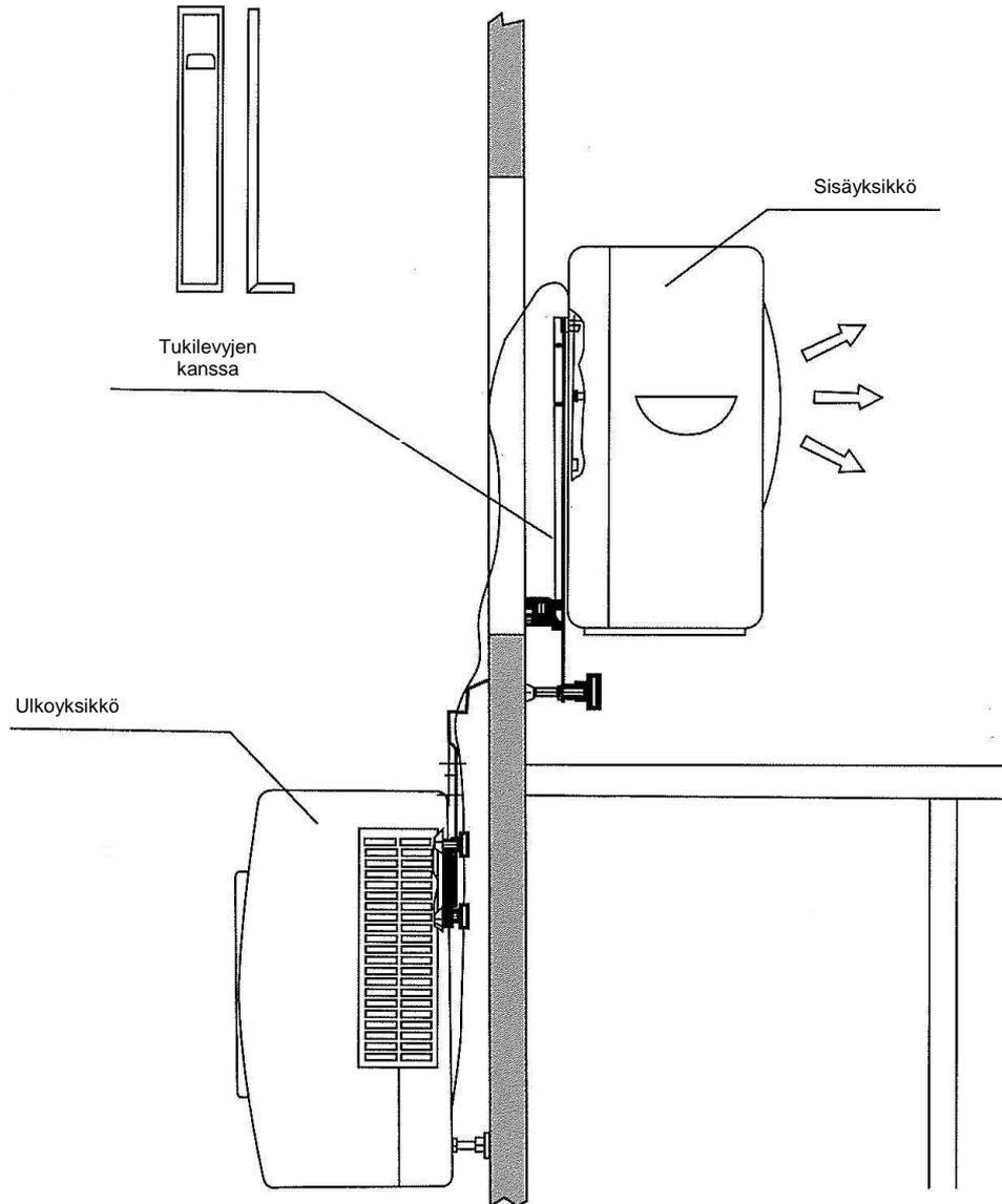
Kiinnitä tukilevyt kannakkeisiin sormimuttereilla tilan sisäpuolelta käsin. Liu'uta sitten sisäyksikkö paikalleen.
