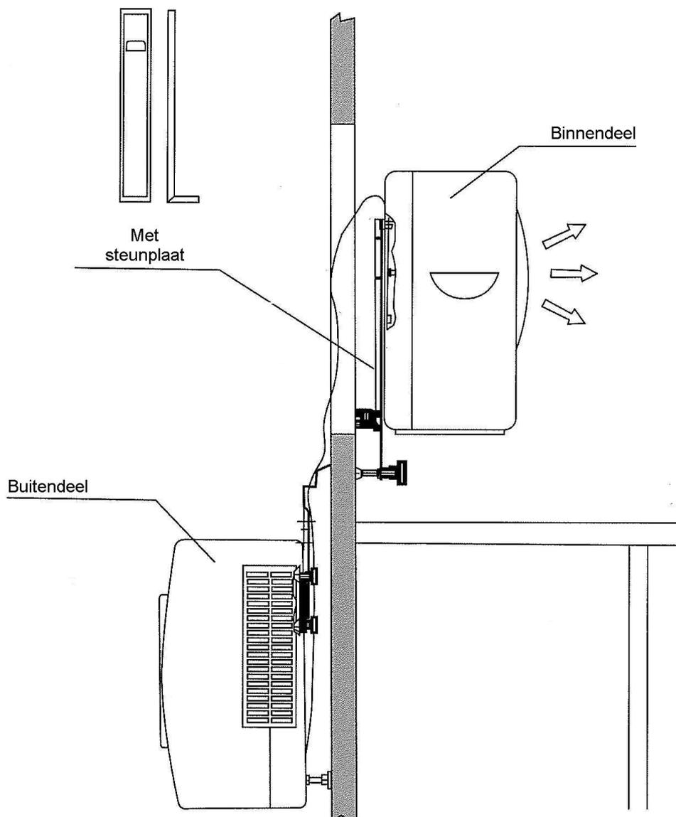
Fissare all'interno delle piastre di supporto sulle staffe utilizzando i due "pulsanti" con interni filettati. Ora puoi far scorrere la parte interna sopra le piastre di supporto.
