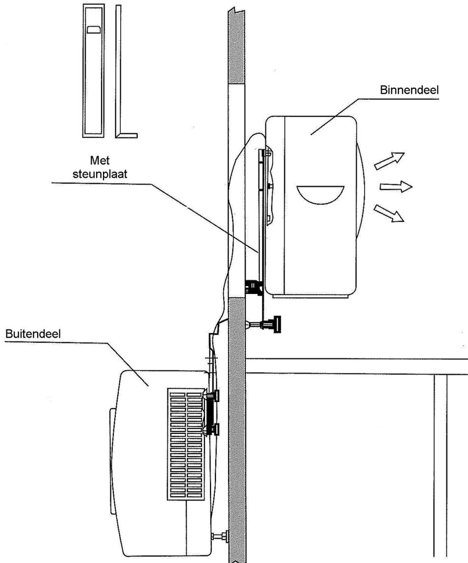
Bevestig binnen de steunplaten op de beugels met behulp van de beide knoppen met binnendraad. Nu kunt u het binnen gedeelte over de steunplaten schuiven.
