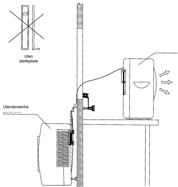
Fest de store brakettene til utendørsenheten på klimaapparatet ved å stramme til vekselvis to håndskruer i kryss per brakett. (To håndskruer sitter allerede på plass, og to håndskruer medfølger i leveranseområdet til apparatet). Heng utendørsenheten på plass på vinduet. Plasser innendørsenheten på et bord eller liknende. **Obs:** det befinner seg en fjernbar blokk på innsiden av den store braketten. Denne må fjernes for enkelte campingvogner (de med tykkere vegger eller vinduskarmer).
