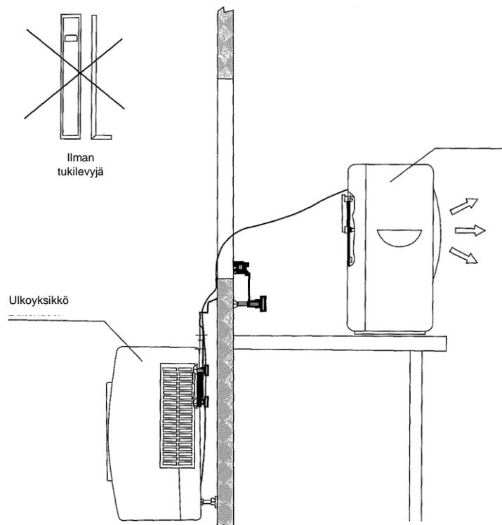
Kiinnitä kannakkeet ulkoyksikköön kiristämällä poikittain kummankin kannakkeen kaksi sormiruuvia. (Kaksi ruuvia on paikallaan ja kaksi ruuvia on erillään pakkauksessa.)
