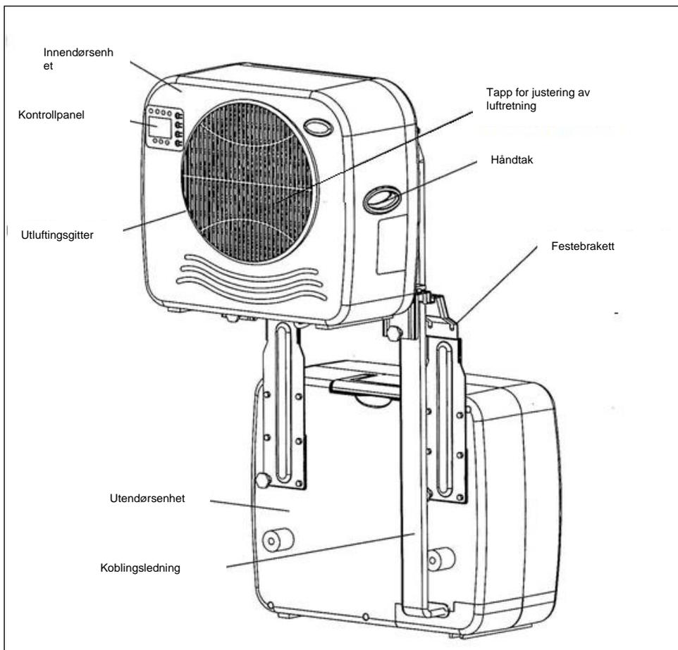
Kontrollpanel, se avsnittet "bruk" for en forklaring av kontrollpanelet
