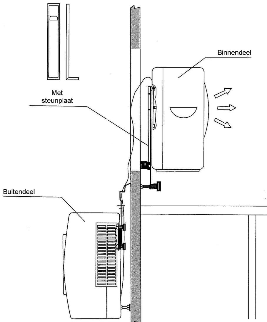
Fäst stödplattorna på byglarna med hjälp av båda knapparna med invändig gänga. Nu kan du skjuta inomhusdelen över stödplattan.
