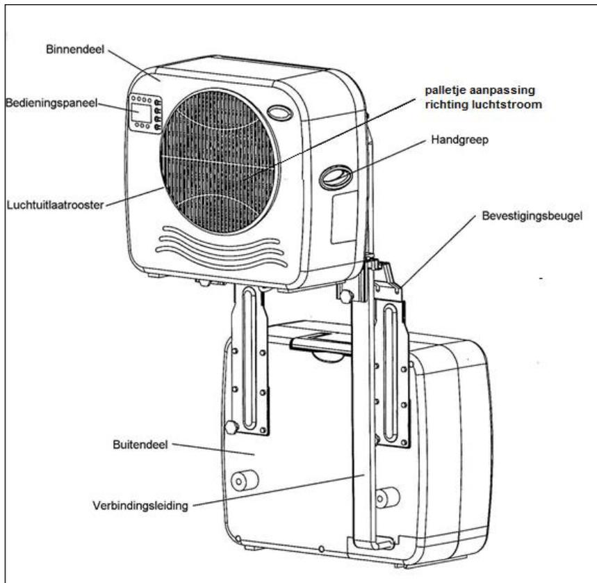
[Inneneinheit, Luftstrom-Richtungsregler, Handgriff, Befestigungsbügel, Verbindungsleitung, Außeneinheit, Luftauslaßgitter, Bedienungskonsole]
