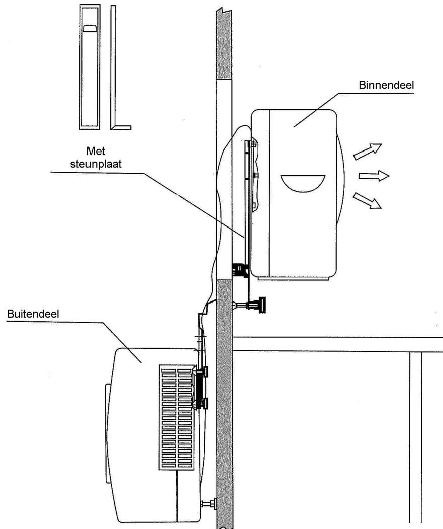
[Mit Stützplatte; Inneneinheit; Außeneinheit]
