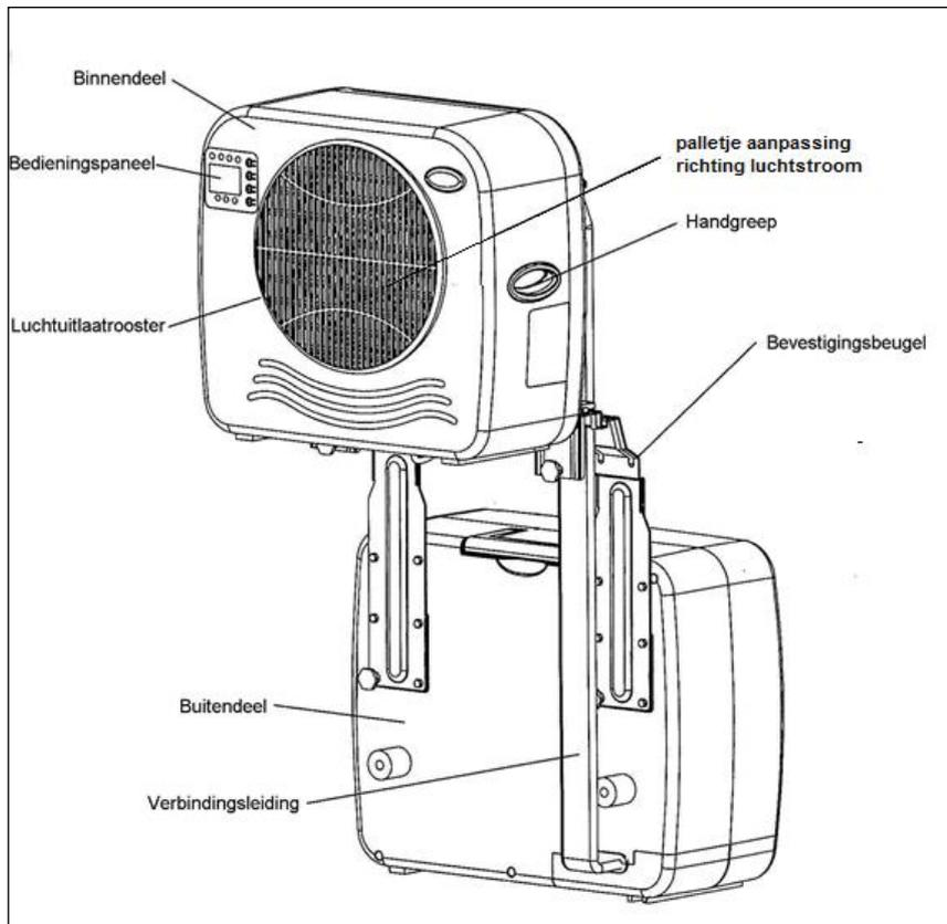
unité intérieure, coussinet de réglage du débit d'air, poignée, grille de sortie d'air, panneau de commande
