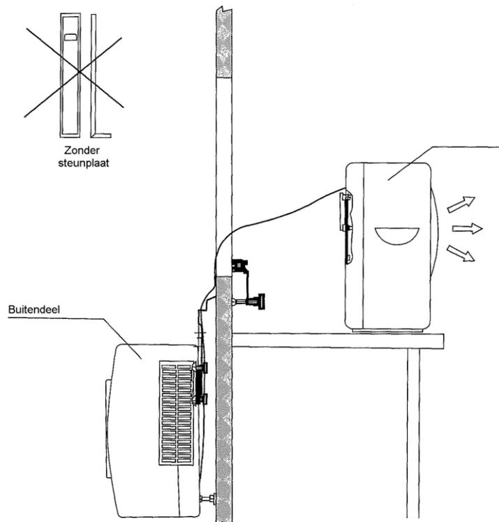
Monter de store bøjler til den udvendige del af klimaanlægget ved at fæstne to skruehætter på tværs pr. beslag. (To skrue sidder allerede hvor de skal, mens to skruehætter leveres separat).
