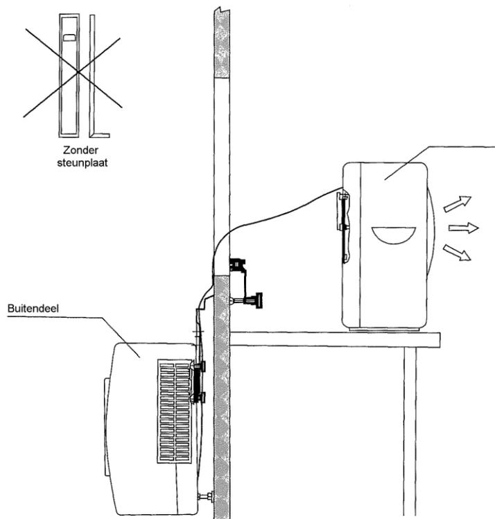
Bevestig de grote beugels aan het buitendeel van de airco, door per beugel twee schroefdoppen kruiselings vast te zetten. (Twee schroeven zitten al op hun plaats, twee schroefdoppen worden los bijgeleverd).
