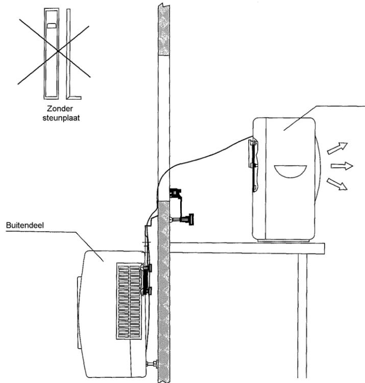
[Ohne Stützplatte, Außeneinheit]
