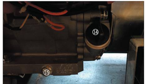
Öffnen Sie den Ölpfropfen (14) und schrauben Sie den Ölablasspfropfen ab. Kippen Sie den Generator und lassen Sie das gebrauchte Motoröl ab. Entsorgen Sie das gebrauchte Motoröl gemäß den jeweiligen örtlichen Vorschriften.
