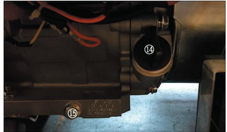
Avaa öljyaukon korkki (14) ja irrota öljyn tyhjennysaukon korkki. Kallista generaattoria ja valuta käytetty moottoriöljy ulos.
