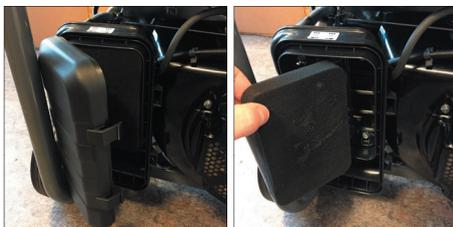
Ta bort filterelementet.
