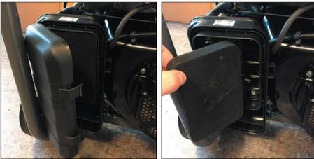
Verwijder het filterelement.
