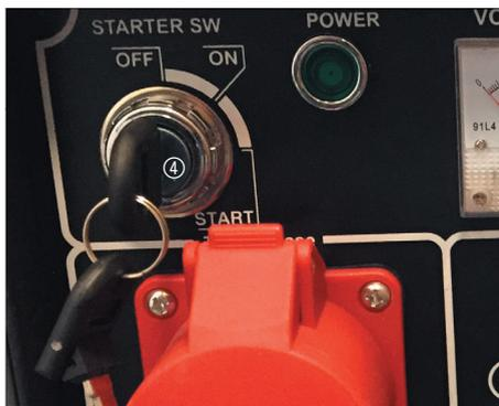
Insérez la clé de contact dans la serrure de démarrage (4) et tournez-la à la position START. Lâchez la clé de contact pour la laisser revenir en position ON dès que le moteur tourne.
