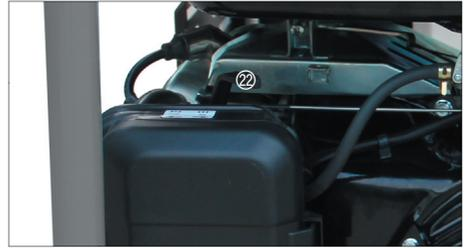
Ponga el estérter (22) en posición OFF para que la mezcla de petróleo sea más rica si el motor está frío. Si el motor está caliente, ponga el estérter en posición ON.
