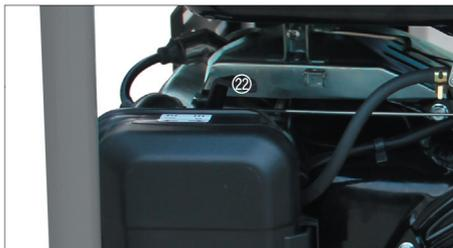
Placez le starter (22) sur la position OFF pour enrichir le mélange carburant si le moteur est froid. Placez le starter sur la position ON si le moteur est chaud.
