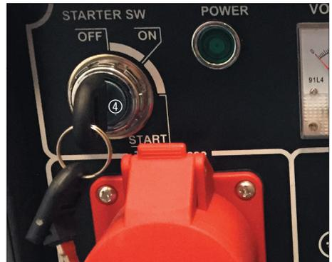
Coloque la llave de ignición en la cerradura de ignición (4), y gire la llave a la posición START. Suelte la llave de ignición de modo que vuelva a la posición ON en cuanto el motor haya arrancado.
