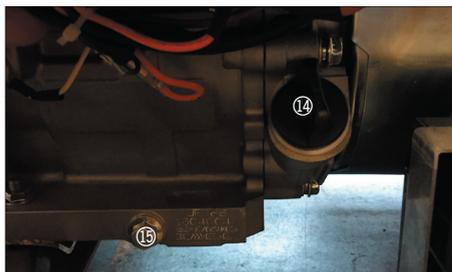
Åpne oljepluggen (14), og skrus av oljetappepluggen. Vipp generatoren, og tapp den brukte motoroljen. Den brukte motoroljen må avhendes i henhold til reglene for avfallshåndtering som gjelder i din kommune.
