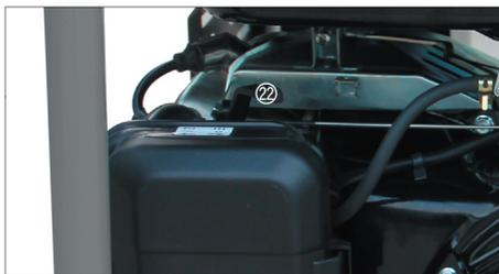
Ustawić przepustnicę (22) w położenie OFF, aby wzbogacić mieszankę paliwową, jeżeli silnik jest zimny. Ustawić przepustnicę w położenie ON, jeżeli silnik jest ciepły.
