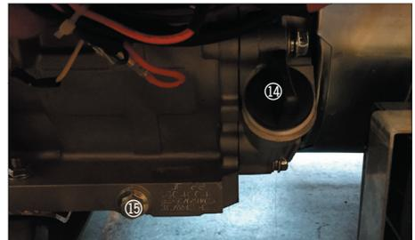
Retirez le bouchon du réservoir d'huile (14) et dévissez le bouchon de vidange d'huile. Inclinez le générateur et vidangez l'huile moteur usagée. Éliminez l'huile usagée selon la réglementation locale en vigueur.
