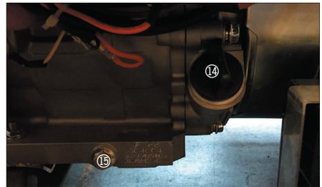
Open de oliedop (14) en schroef de olieafvoerdop los. Kantel de generator en voer de gebruikte motorolie af. Voer de gebruikte olie in overeenstemming met de lokale wet- en regelgevingen af.
