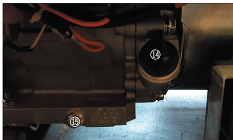
Åbn olieproppen (14), og skru olieaftapningsproppen af. Tip generatoren, og aftap den brugte motorolie. Bortskaf den brugte motorolie i henhold til de regler, der gælder i din kommune.
