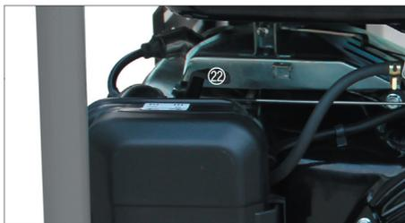
Seadke kütusesegu rikastamiseks õhuklapp (22) asendisse OFF (väljas), kui mootor on külm. Seadke õhuklapp asendisse ON (sees), kui mootor on soe.
