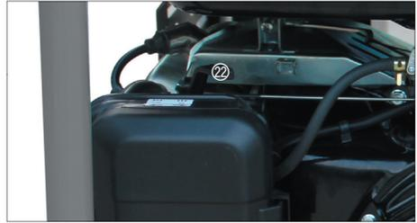
Zet de gasklep (22) in de stand OFF (UIT) om het benzinemengsel rijker te maken wanneer de motor koud is. Zet de gasklep in de stand ON (AAN) als de motor warm is.
