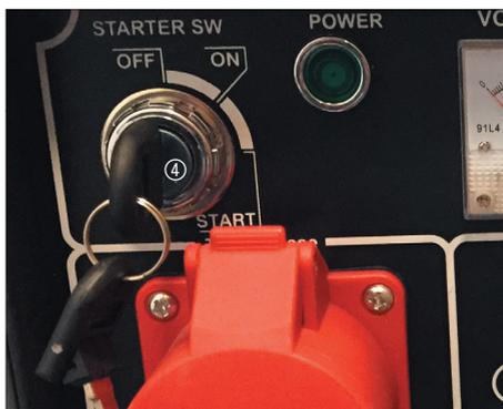
Włożyć kluczyk zapłonu do stacyjki (4) i obrócić go w położenie START. Puścić kluczyk zapłonu, tak aby wrócił w położenie ON, jak tylko silnik zacznie pracować.
