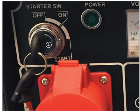
Plaats de ontstekings sleutel in de ontstekingsvergrendeling (4) en draai de sleutel naar de stand START. Laat de ontstekings sleutel los, zodat deze terugkeert naar de stand ON (AAN) zodra de motor begint te draaien.
