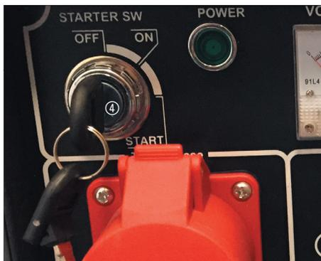
Sæt tændingsnøglen i tændingslåsen (4), og drej tændingsnøglen til positionen ON.
