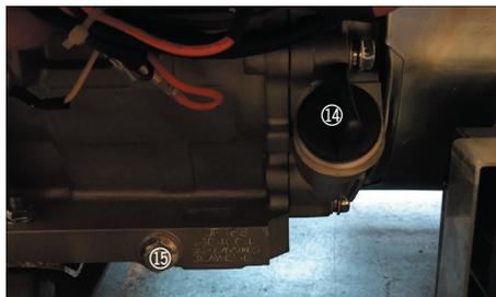
Öppna oljeavtappningsproppen (14) och skruva av den. Tippa generatorn och tappa ur den använda motoroljan. Den använda motoroljan ska kasseras enligt gällande regler i kommunen.
