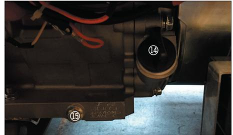
Abra el tapón de aceite (14) y desenrosque la cubierta de drenaje de aceite. Incline el generador y deje salir el aceite de motor usado. Elimine el aceite usado siguiendo las normas y reglamentos aplicables.
