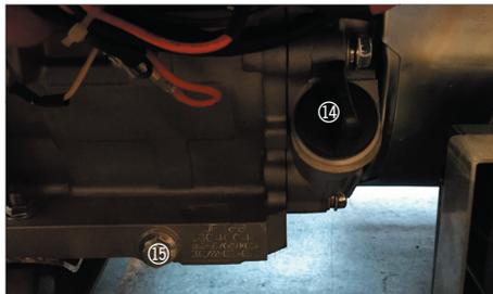
Odkręcić zatyczkę oleju (14) i odkręcić korek do spuszczenia oleju. Przechylić generator i spuścić zużyty olej silnikowy. Zutilizować zużyty olej zgodnie z lokalnymi przepisami i regulacjami.
