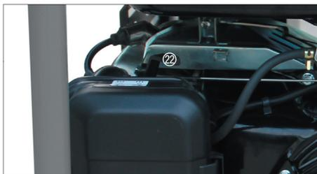
Se il motore è freddo, per rendere più carica la miscela di benzina portare la valvola dell'aria (22) nella posizione di OFF. Se invece il motore è caldo regolare la valvola dell'aria su ON.
