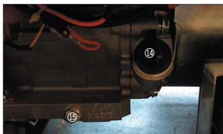
Aprire il tappo dell'olio (14) e svitare il tappo di scarico dell'olio. Tenere inclinato il generatore e attendere che fuoriesca l'olio esausto del motore. Smaltire l'olio esausto nel rispetto delle normative locali vigenti.
