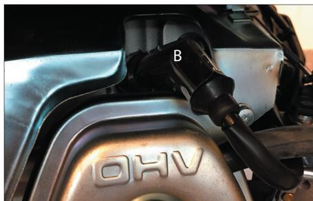
Veeg stof op het gebied rond de bougie weg. Schroef de bougie los met een bougiesleutel. Gebruik een voelmaat om de tussenruimte van de elektrode te meten. Deze moet 0,7-0,8 mm zijn.
